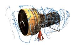
Abb. 4: Turbine mit Scanner-Trajektorie (blaue Linie).
