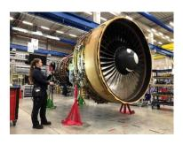
Abb. 3: Eine MTU-Mitarbeiterin digitalisiert ein Triebwerk. © MTU Maintenance
